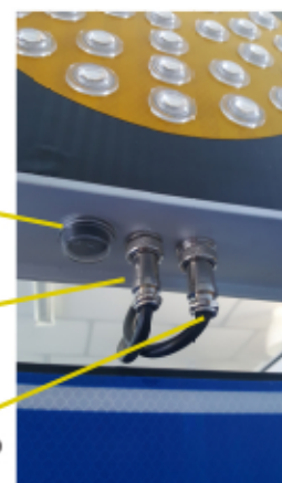
Connettore sensore infrarosso Infrared sensor connector
